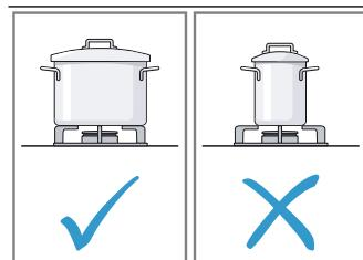
Используйте посуду подходящего размера для каждой горелки. Никогда не ставьте небольшую посуду на большие горелки. Пламя не должно касаться боковых стенок посуды.
