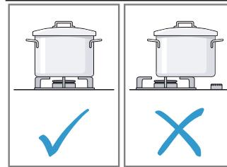
Ставьте посуду точно на середину горелки, иначе она может опрокинуться. Не ставьте посуду большого размера на горелки рядом с регуляторами. Из-за воздействия высоких температур регуляторы могут быть повреждены.
